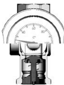
Шаровый кран открыт, обратный клапан в автоматическом режиме.
